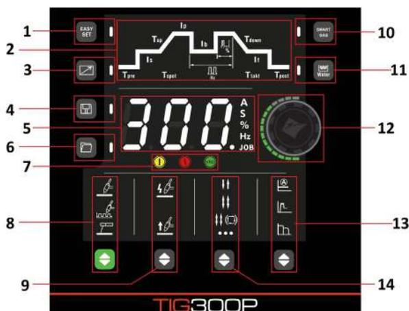
1. Réglage facile : Lorsque le voyant de réglage facile est allumé, le poste à souder passe en mode facile et seul le courant de pointe peut être réglé. Tous les autres paramètres sont prédéfinis en fonction du courant de pointe. Remarque : la fonction de commande à distance n'est pas prise en charge en mode facile (Voir page 23 pour plus de détails).
