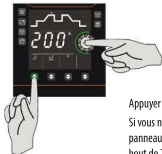
Lorsque la machine est au repos (avant le soudage), maintenez enfoncés le bouton du mode de soudage et le bouton de réglage des paramètres (comme illustré à gauche) pendant 3 secondes pour afficher le numéro de série de la machine.
