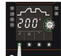
Pour réinitialiser les paramètres d'usine de ET-300P, maintenez enfoncé le bouton du mode de soudage
