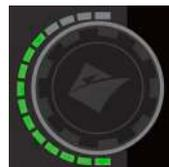
Le paramètre sélectionné et ses valeurs sont affichés par la LED de réglage ainsi que sur les indicateurs numériques. Les LED situées à côté de l'indicateur indiquent si le paramètre est en ampères, secondes, % ou Hz, comme illustré ci-dessus.
