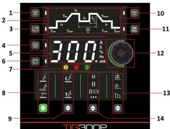
8. Sélecteur et indicateurs TIG, TIG pulsé et MMA : Permet à l'opérateur de basculer entre les modes de soudage MMA et TIG grâce au bouton vert situé en dessous.
