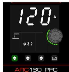
Après avoir sélectionné le diamètre de l'électrode, le système sélectionnera automatiquement le courant de soudage, le courant de démarrage à chaud et la force de l'arc. Les utilisateurs peuvent faire tourner le bouton de réglage en fonction des exigences de soudage pour affiner les paramètres de courant de soudage.
