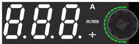
En mode MIG Synergic, en mode MMA ou en mode Lift TIG, le courant est affiché par défaut. Si Synergic est désactivé en mode MIG, la vitesse de dévidage du fil est affichée par défaut.
