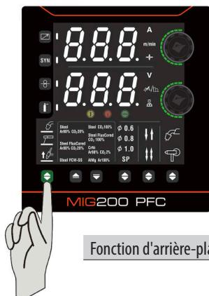
Pour réinitialiser les paramètres d'usine pour l'EM-160C ou l'EM-200C, appuyez et maintenez enfoncé le bouton de mode de soudage
