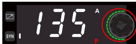
**A** Contrôle de l'ampérage - (la plage de tension de soudage varie en fonction du matériau et de la taille du fil sélectionnés)
