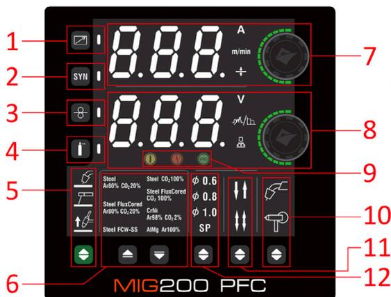
1. Sélection de la télécommande : appuyez sur ce bouton pour régler le contrôle du courant du panneau sur un appareil à distance tel qu'une pédale, un potentiomètre à distance de torche TIG ou un appareil de commande à distance pour MMA. En mode à distance, l'indicateur LED s'allume également.
