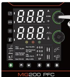
La fonction Welding Engineer Mode permet aux utilisateurs de régler et de définir les paramètres ou les fonctions par défaut d'arrière-plan comme suit : Appuyez sur le bouton de réglage des paramètres supérieur et maintenez-le enfoncé pendant 5 s en état de démarrage.
