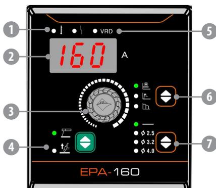
5. Indicateur VRD : Le voyant VRD (dispositif de réduction de tension) s'allume lorsque la machine est en mode MMA et que la fonction VRD est activée.
