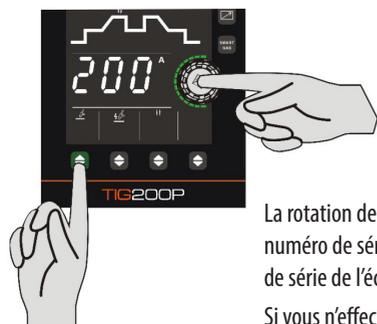
Lorsque la machine est en état de veille (avant le soudage), appuyez et maintenez enfoncés le bouton du mode de soudage et le bouton de réglage des paramètres (comme illustré à gauche) pendant 3 secondes pour afficher le numéro de série de la machine.
