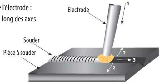
L'opérateur peut choisir la manipulation de l'électrode en fonction du joint de soudage, de la position de soudage, des caractéristiques de l'électrode, du courant de soudage et des compétences de l'opérateur, etc.
