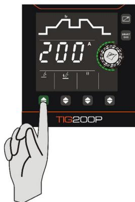
Pour réinitialiser les paramètres d'usine de l'ET-200 ou de l'ET-200P, appuyez et maintenez le mode de soudage
