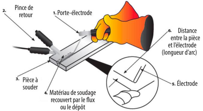
Le courant de soudage circule dans le circuit dès que l'électrode entre en contact avec la pièce à souder. Le soudeur doit toujours veiller à la bonne connexion de la pince de travail. Plus la pince est placée près de la zone de soudage, mieux c'est.
