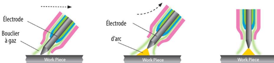
pièce et contaminer la soudure. La principale difficulté du soudage TIG à l'arc est de maintenir l'électrode propre. S'il est essentiel de frapper rapidement l'électrode sur le métal et de ne pas la soulever de plus de 3 mm pour créer l'arc, il faut également s'assurer que le métal est parfaitement propre.
