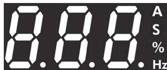
Lorsque la machine ne soude pas, la valeur prédéfinie du courant de soudage sera automatiquement affichée. Lorsque la machine soude, la valeur « réelle » du courant de soudage de sortie est affichée.
