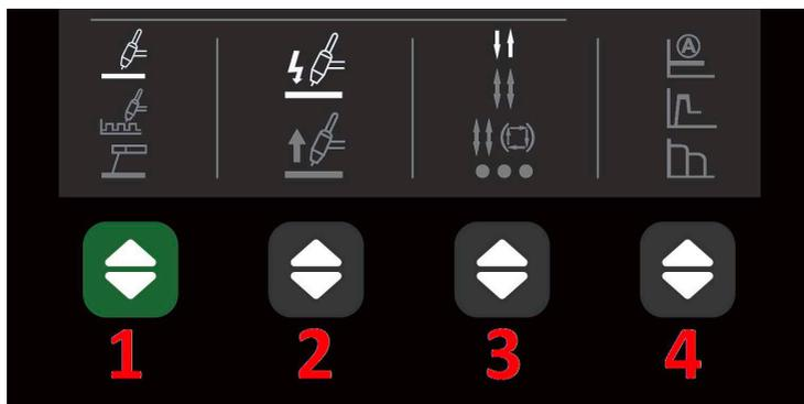
Ces zones d'options TIG et MMA (illustrées ci-dessus) se décomposent en 4 zones, le mode de processus de soudage TIG et MMA, le commutateur d'allumage de l'arc HF pour l'allumage HF ou le démarrage de l'arc TIG lift, le mode de déclenchement de la torche TIG et les commandes MMA qui sont décrites dans un petit plus de détails comme ci-dessous:
