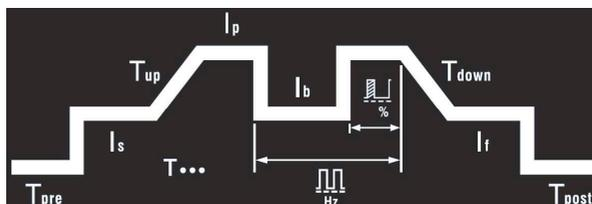
La zone de sélection des paramètres TIG, comme indiqué ci-dessus, montre le flux du processus lors du soudage TIG. Appuyer sur la molette de commande de réglage mettra en surbrillance le voyant LED  $I_p$ , puis tourner la molette de commande vous fera défiler les autres paramètres dans la zone de sélection.
