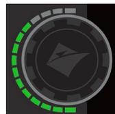
Le paramètre sélectionné et les valeurs des paramètres sont affichés via la LED du paramètre ainsi que sur les compteurs à affichage numérique et les LED à côté du compteur indiquent si le paramètre est en ampères, secondes, % ou Hz comme indiqué ci-dessus.
