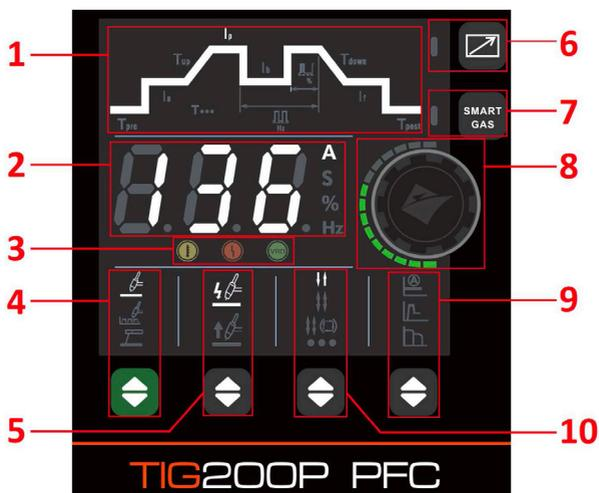
1. Zone de sélection des paramètres TIG : appuyer sur le bouton de réglage (8) mettra en surbrillance la LED du paramètre à régler dans la zone de sélection (le modèle ET-200 n'affiche pas l'option d'impulsion).
