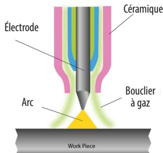
Le procédé de soudage TIG peut être AC ou DC. L'ET200 et l'ET-200P sont des machines à courant continu (courant continu) pour le soudage de l'acier, de l'acier inoxydable, du cuivre, etc., tandis qu'en AC (Courant alternatif) serait utilisé pour souder l'aluminium et ses alliages.
