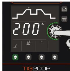
Pour accéder à la protection de la tension d'entrée, tournez la molette de commande jusqu'à ce que « F02 » s'affiche à l'écran et appuyez à nouveau sur la molette de commande pour accéder à ce paramètre. Maintenant, tournez la molette de commande dans le sens des aiguilles d'une montre/dans le sens inverse des aiguilles d'une montre pour modifier le paramètre de protection contre les surtensions et les sous-tensions sur :
