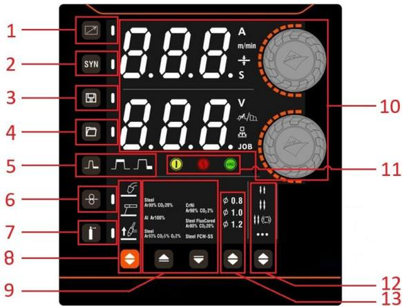
1. Fernbedienungsauswahl: Durch Drücken dieser Taste wird die Stromsteuerung vom Bedienfeld auf ein externes Gerät wie ein Fußpedal oder ein Handgerät umgeschaltet. Im Fernbedienungsmodus leuchtet die LED-Anzeige.
