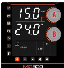
Durch Drehen des oberen Drehreglers (A) auf einem der Displays wird die Drahtvorschubgeschwindigkeit erhöht oder verringert.
