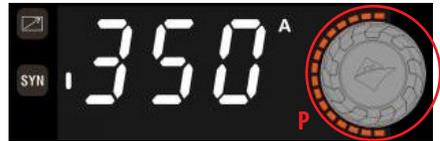
Der kombinierte Drehgeber und Druckknopf, der den Bediener
