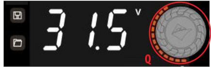
Der kombinierte Drehgeber und Druckknopf, der den Bediener beim Drücken durch Schweißspannung, Lichtbogenlänge, Induktivität und Rückbrand scrollt, wie unten dargestellt:
