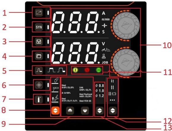
9. Material- und Gasauswahlbereich: Durch Drücken der Auf- oder Ab-Tasten können Sie durch die voreingestellten Material- und Gaskombinationen blättern. Die Auswahl erfolgt über die Auswahltaste (je nach gewählttem Material).
