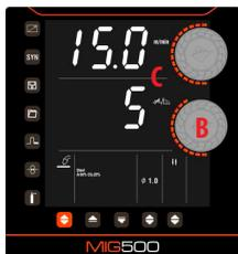
Wie oben erwähnt, wird standardmäßig die Schweißspannung (C) angezeigt. Um zur Induktivitätsregelung zu wechseln, drücken Sie einmal auf den unteren Drehregler (B) auf einem der Displays. Das Symbol wechselt von „V“ zu  $\mu$  und zeigt damit an, dass Sie sich nun in der Induktivitätsregelung befinden.
