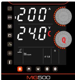
Schweißspannung wird angezeigt
