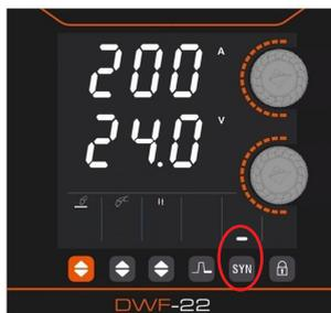
Die obigen Abbildungen des digitalen Bedienfelds des EVO EM-500S (oder EM-350S) und der Drahtvorschubeinheit DWF-22 zeigen die Maschine im synergetischen MIG-Modus. Auf den folgenden Seiten werden die Einrichtungsschritte erläutert.
