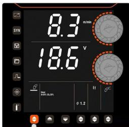
Um die Werkseinstellungen des EM-350S und EM-500S wiederherzustellen, halten Sie die Schweißmodus-Taste gedrückt. ➡ 5 Sekunden lang gedrückt halten, um alle Werkseinstellungen wiederherzustellen.
