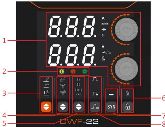
Das digitale Bedienfeld des Benutzers der Drahtvorschubeinheit arbeitet mit dem digitalen Bedienfeld der Stromquelle zusammen. Sie werden also feststellen, dass einige Bedienelemente zur Vereinfachung für den Bediener doppelt vorhanden sind.
