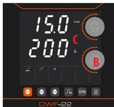
Durch Drehen des unteren Steuerrads (B) auf einem der Displays wird die Rückbrennzeit erhöht oder verringert (der Einstellbereich für die Rückbrennzeit beträgt 0,2 bis 2,0 s).
