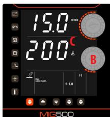
Durch Drehen des unteren Drehreglers (B) auf einem der Displays wird die Induktivität erhöht oder verringert. (Der Einstellbereich der Induktivität liegt zwischen  $-10$  und  $+10$ .)
