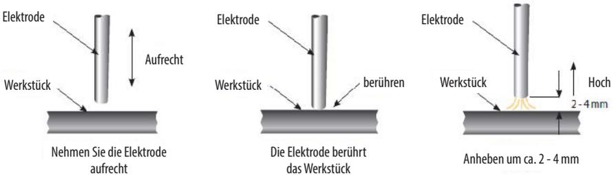
**Scratch-Technik**-Ziehen Sie die Elektrode und kratzen Sie das Werkstück, als würden Sie ein Streichholz anzünden. Das Kratzen an der Elektrode kann dazu führen, dass der Lichtbogen entlang der Kratzbahn brennt. Achten Sie daher darauf, im Schweißbereich zu kratzen. Nehmen Sie nach dem Zünden des Lichtbogens die richtige Schweißposition ein.
