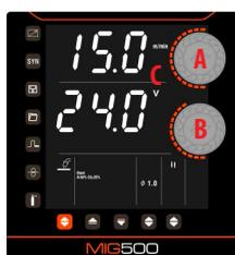
Tourner la molette de commande supérieure (A) sur l'un ou l'autre écran permet d'augmenter ou de diminuer la vitesse de dévidage du fil.
