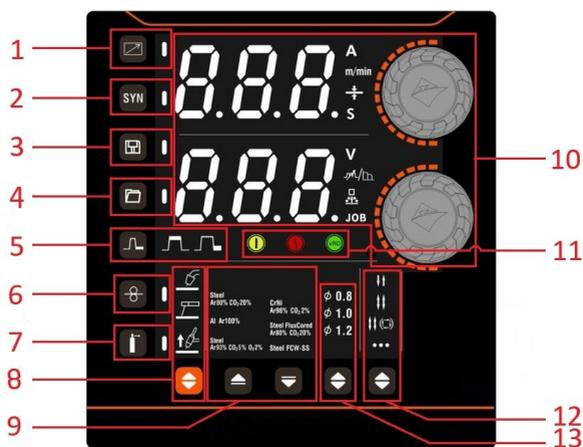
1. Sélection de la télécommande : Appuyez sur ce bouton pour régler le courant depuis le panneau vers un appareil distant, tel qu'une pédale ou un appareil portatif. En mode distant, le voyant LED s'allume également.
