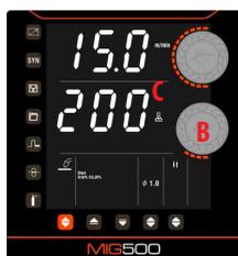
Tourner la molette de commande inférieure (B) sur l'un ou l'autre écran permet d'augmenter ou de diminuer l'inductance. (La plage de réglage de l'inductance est de -10 à +10).
