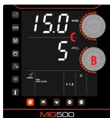
(La plage de réglage de la tension de soudage est de 10 à 40 V).
