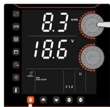
Lorsque la machine est au repos (avant le soudage), maintenez enfoncés le bouton de mode de soudage et le bouton de réglage des paramètres (comme illustré à gauche) pendant 3 secondes pour afficher le numéro de série de la machine.
