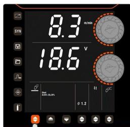
Pour réinitialiser les paramètres d'usine des EM-350S et EM-500S, maintenez enfoncé le mode de soudage
